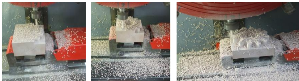
Figura 3: Prelucrări faza de degroșare și finisare
