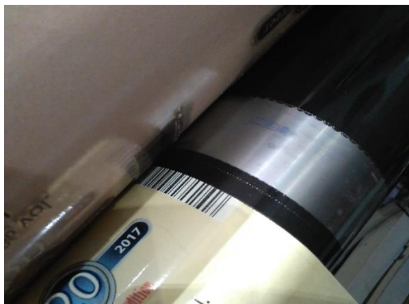
Figura 19: Reacție între Opaque White și Black: în zona codului de bare cerneala Black este intensă
