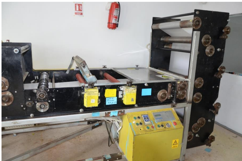
Figura 2: Fețele laterale și cadrul rigid al plastifiatorului
