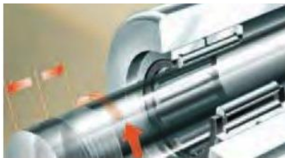
Fig. 17. Lăgăruirea valțurilor baladoare (schimbarea lăgăruirii) [2]
