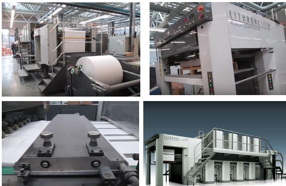
Fig. 22. Sistem de alimentare inline sheeter [8]
